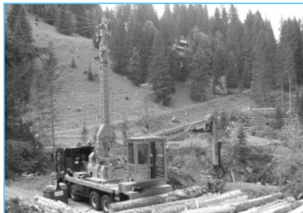
Les systèmes complètement intégrés, câble-mât, grue et tête de façonnage, ont fait leur apparition en France en 2002.
