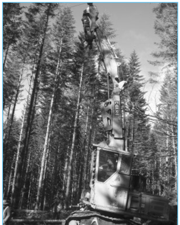
Le yoader, câble-mât dérivé d'une pelle hydraulique, est utilisé pour du téléphéage sur de courtes distances.
